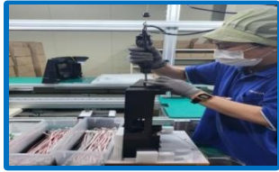
센서 PBA 조립 (가스, 먼지, 온습도)
