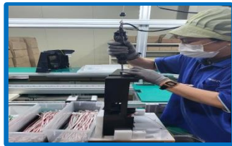
센서 PBA 조립 (가스, 먼지, 온습도)
